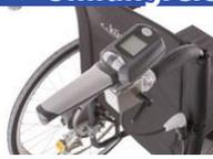
Halterung für Bediengerät als Begleitsteuerung
