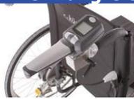
Halterung für Bediengerät als Begleitsteuerung
